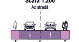
Profil transversal 3 - 3 propus Stradă categoria IV Scala 1:200
